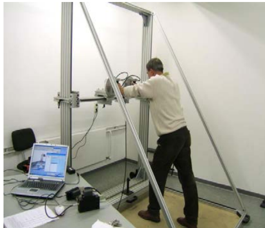
Abbildung 1: Mobiles und modulares Messsystem zur Messung von isometrischen dreidimensionalen Schulter-Arm –Ganzkörperkräften
