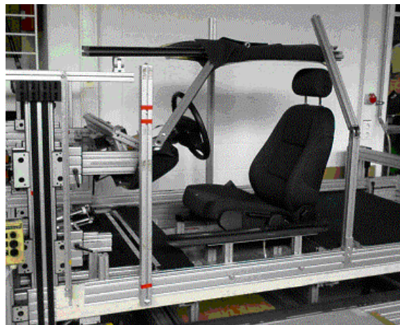
Abbildung 1: Mock-up mit Verstellmöglichkeiten der Ein-Ausstiegbeeinflussenden Geometrien
