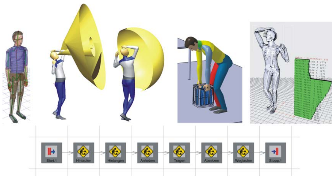
Abbildung 1: Funktionen digitaler Menschmodelle (v.l.n.r.): Visualisierung, Sichtanalyse, Erreichbarkeitsanalyse, Belastungsanalyse, Komfortanalyse, Prozessanalyse (unten)
