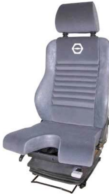
Abbildung 2: Ausgewählter Sitz für den Einsatz im Kranführerstand der Müllverbrennungsanlage. Die Aussparung auf der Sitzvorderseite ermöglicht eine verbesserte Körperhaltung bei Blick nach unten im Vergleich zum Sitz ohne Aussparung
