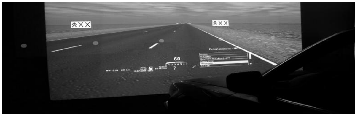
Abbildung 1: LCT-Fahraufgabe, HUD und PDT-Punkte (fünf Positionen im Bereich von 0^\circ und \pm 23^\circ des Sehfeldes)
