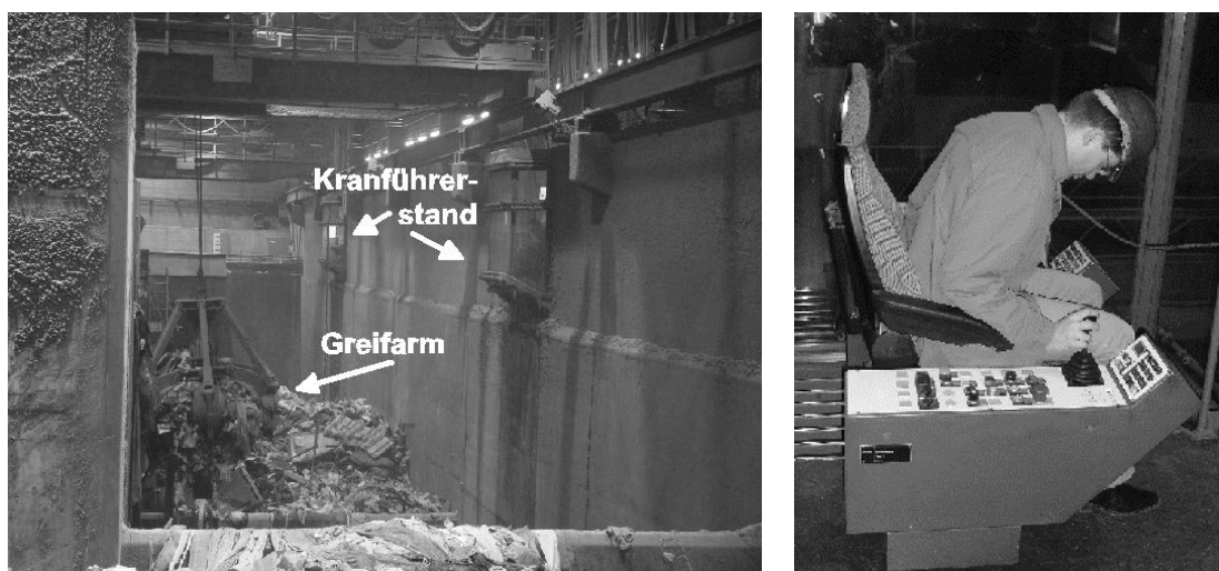
Abbildung 1: Zwischenlagerung des Kehrichts im Silo (links). Sitzhaltung bei Sichtkontrolle der vertikalen Position des Armes des Kranes (rechts)
