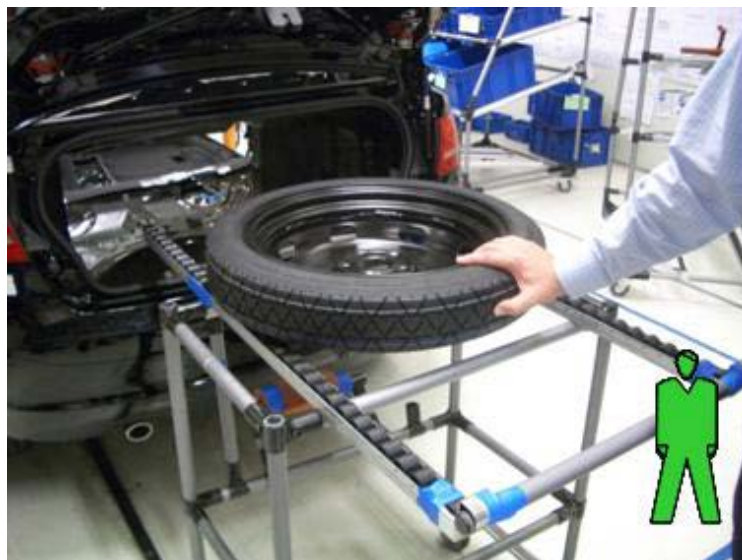
Abbildung 1: Gestaltungsverbesserung in einem Planungs-Workshop: Einbringen des Reserverads über eine Rollenbahn
