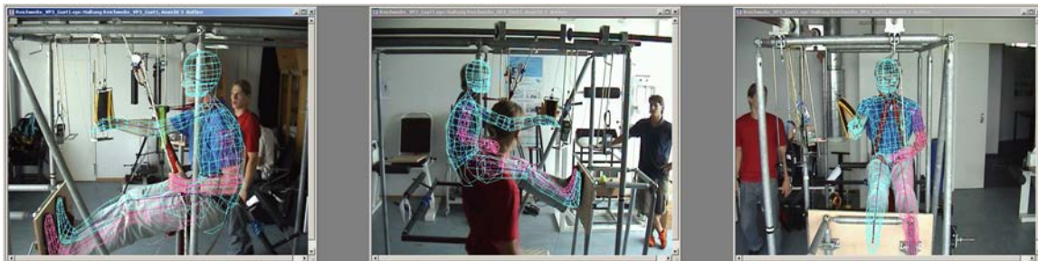
Abbildung 2: Kraftanalysen und Körperwinkelstellung mit Hilfe der PCMAN-Auswertung Anthroanpassung – 3 Haltungen jedes Probanden wurden erfasst
