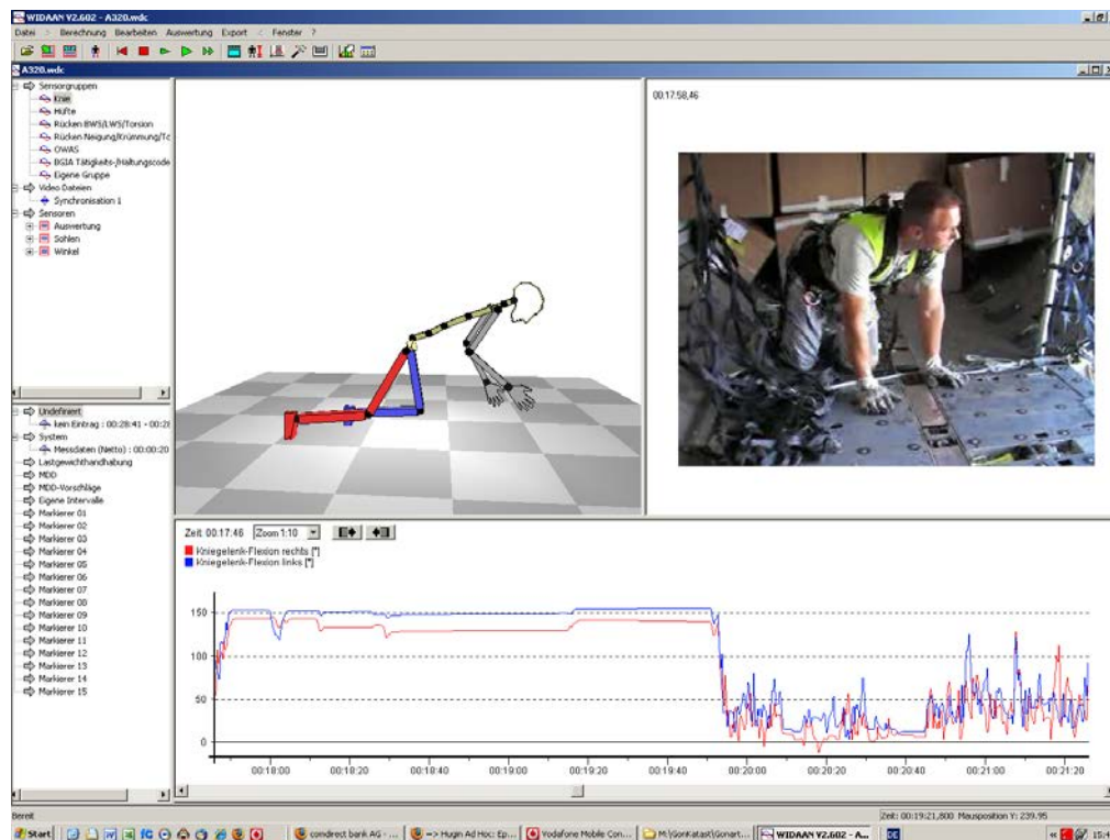
Abbildung 1: CUELA-Messsystem mit eingespielter Videodokumentation
