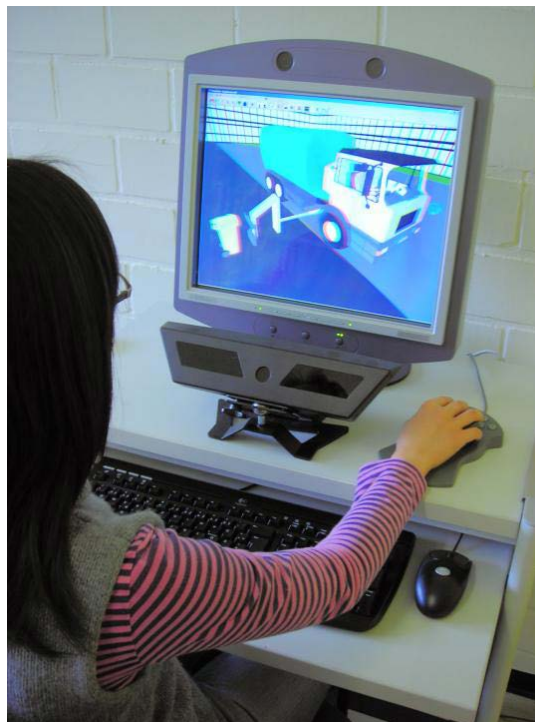
Abbildung 2: Prototypische Realisierung von ErgoViz mit einem autostereoskopischen Bildschirm (SeeReal C-i) und einem Gerät zur Blickbewegungsregistrierung (Tobii x50)
