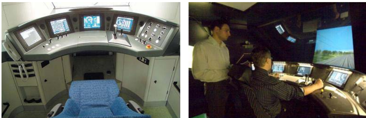
Abbildung 1: a: Design-Modell der Führerkabine, b: Funktionsmodell des Führertisches im Simulator
