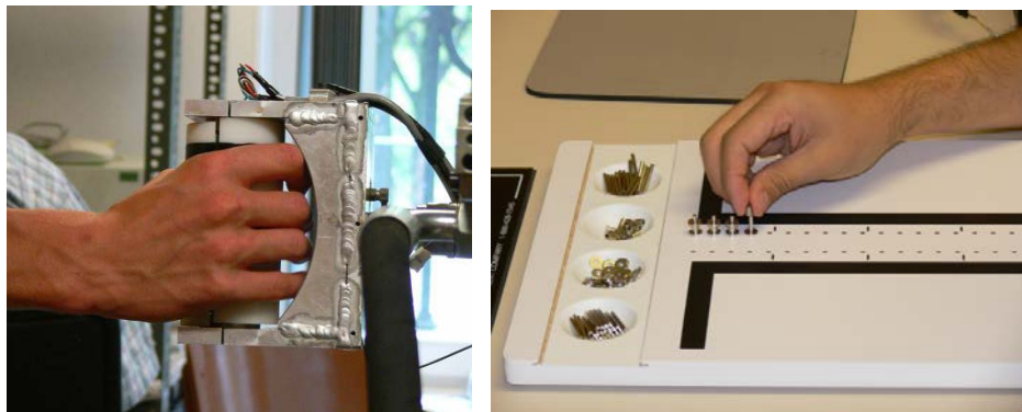
Abbildung 1: Griff mit Greifkraftmesseinrichtung am Simulator / Purdue-Steckbrett
