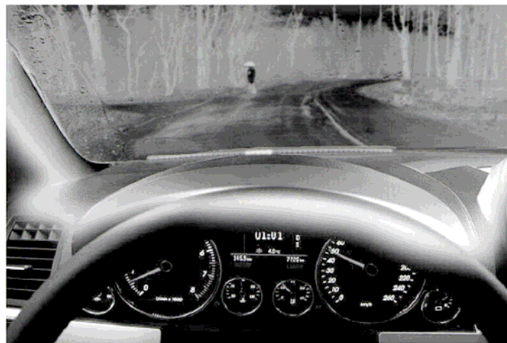
Abbildung 1: Fern-Infrarot-System mit automatischer Fußgängererkennung und event-basierter Warnung mittels LED-Anzeige aus Mahlke et al. (2007)
