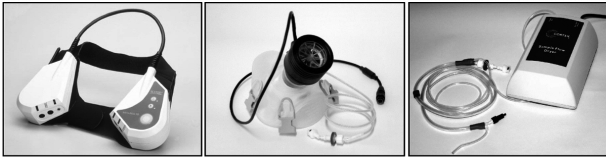
Abbildung 1: Mobiles Ergospirometer MetaMax 3B (links), Atemmaske mit Volumensensor (Mitte) und Trockenschlaucheinheit mit Absaugstrecke (rechts)
