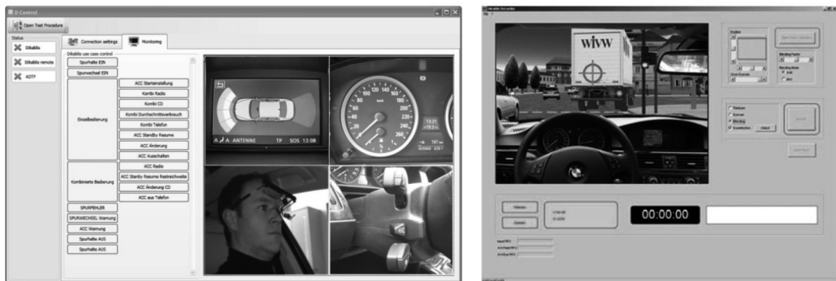
Abbildung 1: Links: Oberfläche von D-Control mit visualisiertem Versuchsbaum und Anzeige der vier externen Videos; Rechts: Oberfläche der Dikablis Software mit Echtzeitansicht des Blickverhaltens
