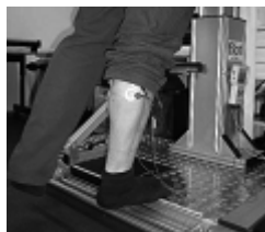
Abbildung 1: Teststand für die elektromyographische Messung des m. gastrocn. medialis und lateralis
