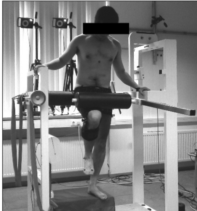
Abbildung 1: Hüftflexionsmessung eines Probanden mit angelegter Kniestütze
