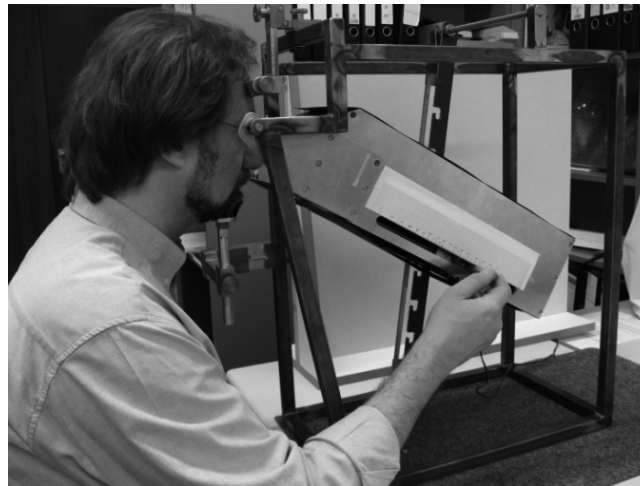
Abbildung 1: Ansicht des Neigungsoptometers: ein Proband variiert den Sehabstand des Sehobjektes im Optometer, das auf eine Neigung von 30 Grad eingestellt ist
