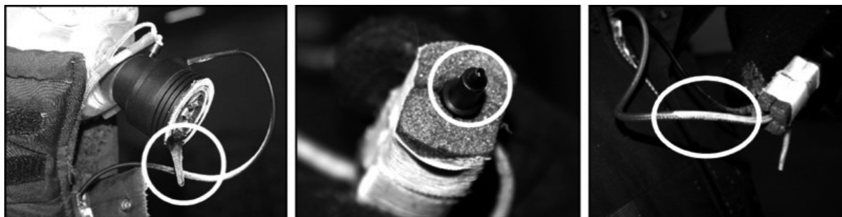
Abbildung 2: Erkennbare Eisbildung am Gehäuse des Volumensensors (links), an der Spitze der Ansaugdüse (Mitte) und am weiterführenden Schlauchsystem (rechts)
