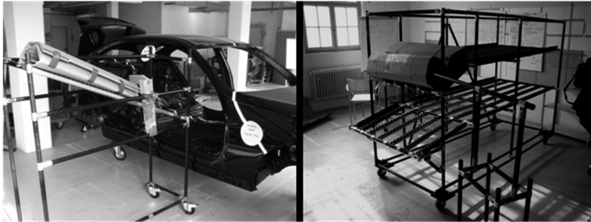
Abbildung 2: Kartonagensimulation der beiden Varianten mit den besten Ergebnissen
